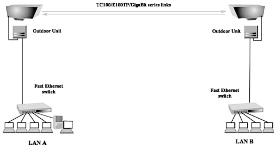
Figure 10: Connexion de deux réseaux locaux par liaison laser
